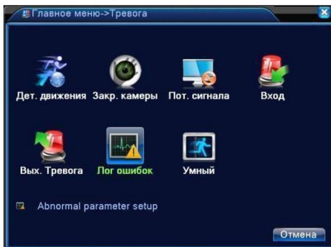
Анализ и проверка текущего программного и аппаратного обеспечения устройства: При возникновении каких-либо отклонений от нормы устройство выдаст соответствующий ответ, например, сообщение или звуковой сигнал.
